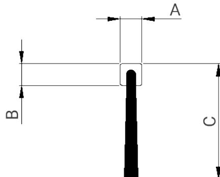
Extrudierter quadratischer Fuß zur Abdichtung von Drehtüren, Rolltreppen, Garagentüren und Industrietüren. Monofilamentgarn aus Polypropylen. Erhältlich auch aus Polyamid 6 bei Bestellungen zu bestimmten Mengen-, Preis- und Zeitkonditionen. Andere Fußvarianten und Abmessungen sind auf Anfrage erhältlich
