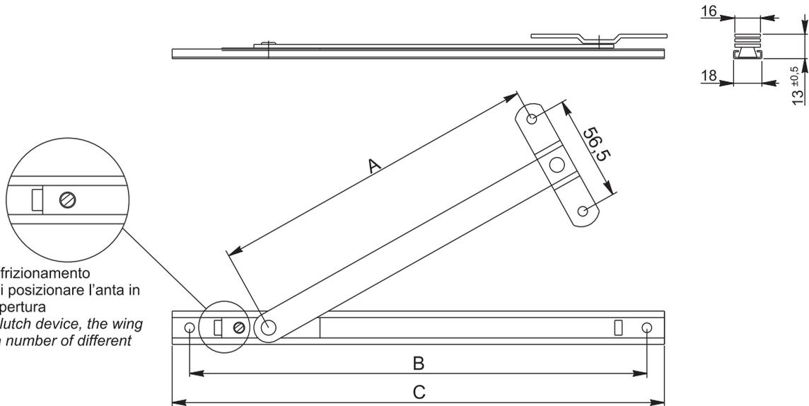
Questo dispositivo di frizionamento regolabile consente di posizionare l'anta in varie angolazioni di apertura
