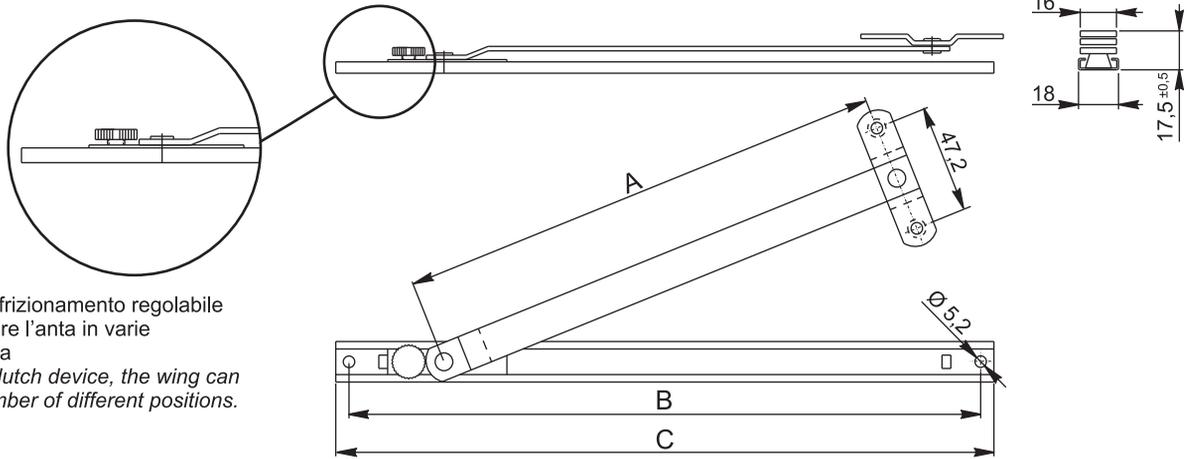
Questo dispositivo di frizionamento regolabile consente di posizionare l'anta in varie angolazioni di apertura
