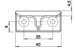
ATTENZIONE: il foro di preparazione per la vite di fissaggio deve avere diametro di 3,25 mm.
