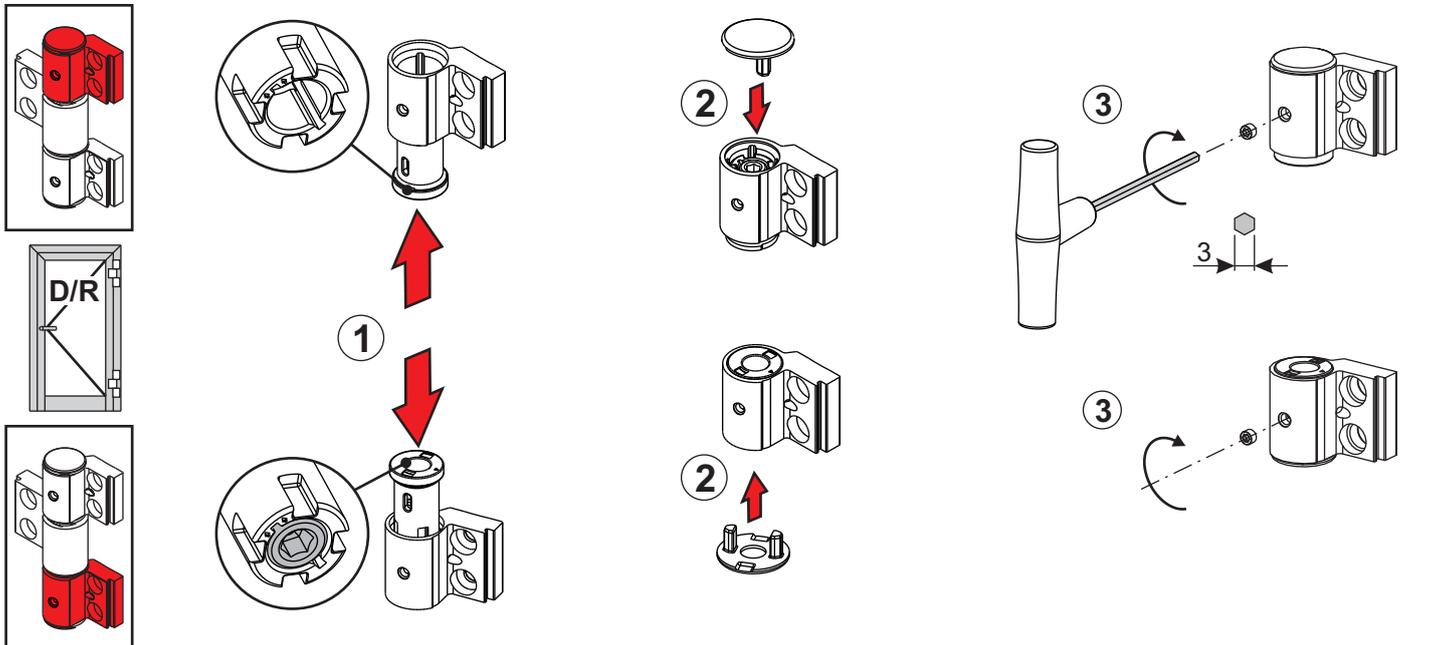
SISTEMI DI FISSAGGIO - FIXING SYSTEMS - SYSTEMES DE FIXATION - SISTEMA DE FIJACION - BEFESTIGUNGSSYSTEME - СИСТЕМЫ КРЕПЛЕНИЯ
