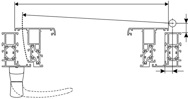
L'impiego di cerniere in sostituzione di bracci top-hung o side-hung è subordinato alla geometria del nodo del profilo, alla dimensione dell'infisso e alla cerniera impiegata.
