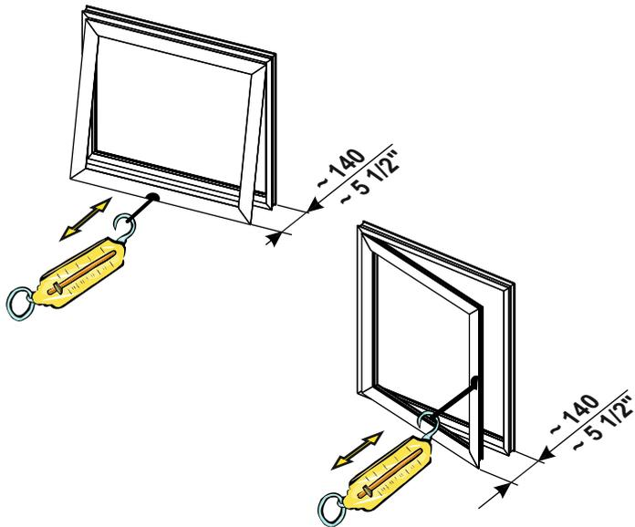
La forza frontale per aprire/chiudere l'anta deve essere < 50N. Per forze >35N è obbligatorio l'impiego di bracci "loose rivet" (La determinazione della forza deve essere seguitata tramite strumenti idonei quali: dinamometro , cella di carico o bilancella).
