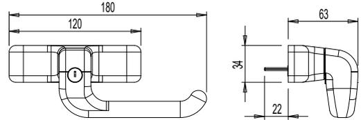
Mecanizado distancia entre ejes 98 mm
