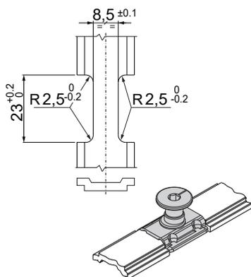
Raccord sur élément de jonction
