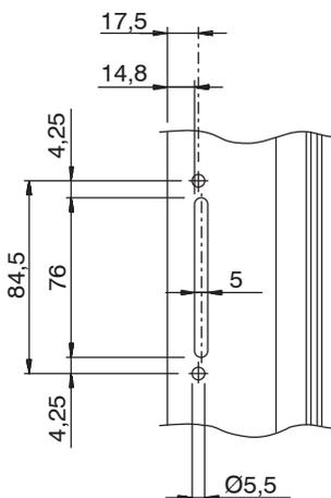
Usinagem do entre-eixo de 98 mm
