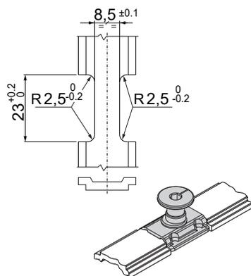
Установка в соединительный элемент
