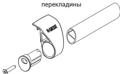
Установка заглушки, закрывающей торцы переключателя
