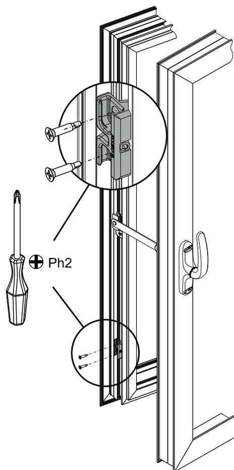
Регулировка вентиляционной щели
