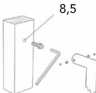
Kit di fissaggio per maniglione singolo non passante per porte in legno.
