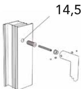
Kit di fissaggio per maniglione singolo non passante per porte in alluminio doppia camera.
