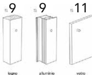
Kit di fissaggio per porte in legno, alluminio, vetro, PVC (in dotazione standard per ogni maniglione).
