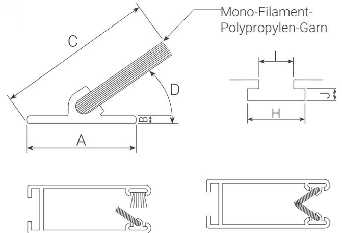
Unbehandeltes Mono-Filament-Garn mit extrudierter Basis. Erhältlich mit einem Winkel von 35°, 45° oder 60°. Garantierte Bürstenzentrierung, geeignet für maschinelles Einsetzen. Wird vorwiegend in die seitlichen Führungsschienen von Insektenschutzrollos eingesetzt. Kann einzeln mit einer flexiblen Standardbürste oder in Doppel-Ausführung eingesetzt werden, um das Gitter in den Führungsschienen zu halten.
