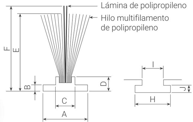
Hilo multifilamento suave siliconizado sobre base extruida. Garantizado en centro del burlete, más adecuado para inserción con máquina. Con lámina central transparente para mejorar el sellado de ventanas y puertas correderas. Base adhesiva opcional.
