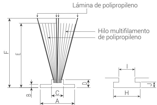
Hilo multifilamento suave siliconizado sobre base extruida. Garantizado en centro del burlete, más adecuado para inserción con máquina. Con lámina central de no tejido para mejorar el sellado de ventanas y puertas correderas.
