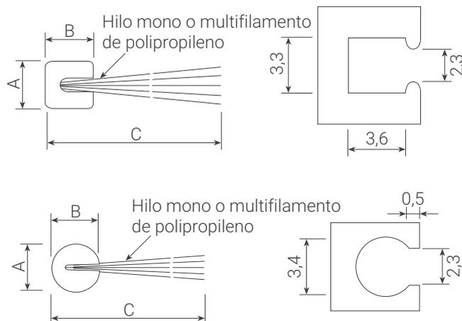
Base extruida cuadrada o redonda para sellado de huecos en los bordes de puertas batientes, persianas y otras aplicaciones similares de perfil estrecho. Hilo monofilamento de 6 hebras no siliconizado más rígido o hilo multifilamento siliconizado más suave. Otras formas y dimensiones de base disponibles previa petición.
