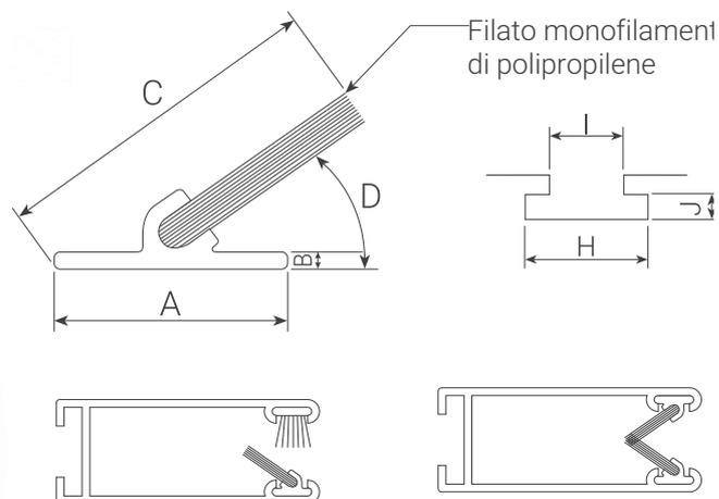
Filato monofilamento trattato con silicone con base estrusa. Disponibile con inclinazione di 35°, 45° o 60°. Garanzia di perfetta centratura dello spazzolino, ideale per l'inserimento automatico. Trova applicazione principalmente nelle guide laterali delle zanzariere avvolgibili. Installabile nella versione standard con spazzolino più morbido singolo oppure doppio, per mantenere la rete all'interno delle guide.
