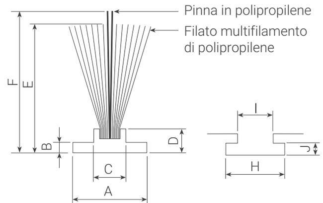
Spazzolino in morbido filato multifilamento trattato con silicone su una base estrusa. Garanzia di perfetta centratura dello spazzolino, ideale per l'inserimento automatico. Con pinna centrale trasparente per ridurre le infiltrazioni da finestre e porte scorrevoli. Supporto adesivo a richiesta.
