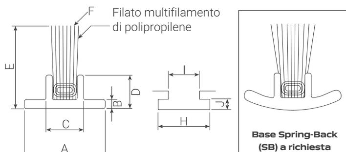
Spazzolino in morbido filato multifilamento trattato con silicone su una base estrusa con guide verticali di orientamento. Garanzia di perfetta centratura dello spazzolino, ideale per l'inserimento automatico. Supporto adesivo a richiesta.
