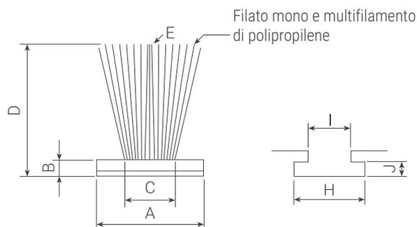
Spazzolino in tessuto su un supporto traslucido. Morbido filato trattato con silicone, parzialmente rinforzato con monofilamento non trattato più rigido. Si utilizza in genere per sigillare gli incastri con forma a T delle guide laterali di serrande avvolgibili o prodotti simili. Supporto adesivo a richiesta.
