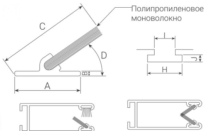
Обработанное силиконом волокно с экструдированным основанием. Доступны варианты расположения под углом 35°, 45° или 60°. Оптимален для центральной щетки, подходит для машинной установки. В основном применяется в боковых направляющих каналах для роллет с москитной сеткой. Может быть установлен с одной стороны вместе с более мягкой стандартной щеткой или с двух сторон для удержания сетки в направляющих.
