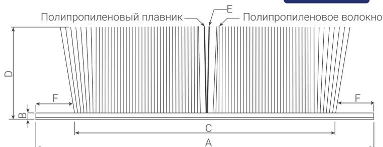
Мягкое многофиламентное волокно, обработанное силиконом, на тканой прозрачной основе с усилением. Доступен в отрезках по размеру и в бобиных для узкого и более широкого применения в качестве уплотняющих решений для раздвижных дверей или мебели. Дополнительная клейкая основа, плавники и моноволоконные кромки.
